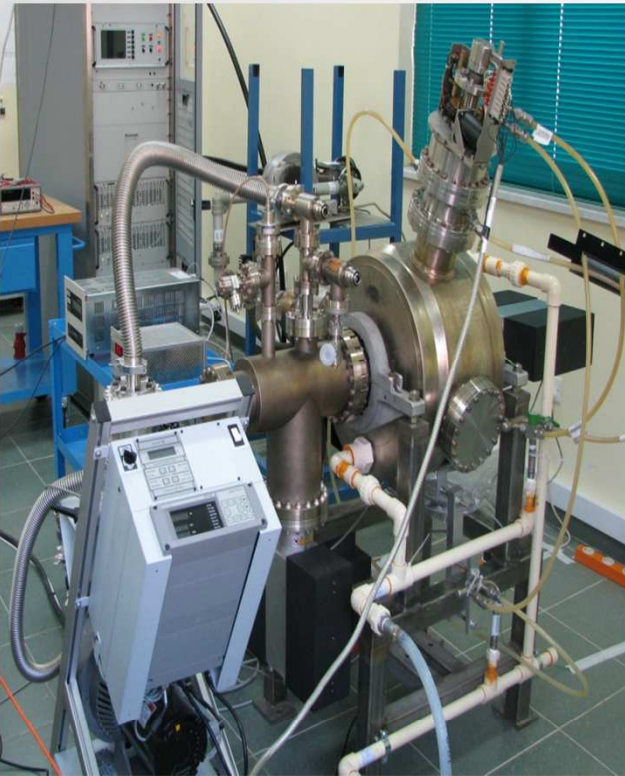
Booster 2KW RF Cavity (BESSY1)
