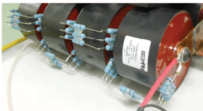
Figura 57. Detalle de las resistencias de descarga conectadas en paralelo con los condensadores.
