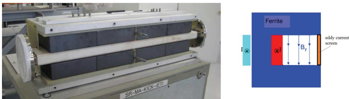
Figura 36. *Kicker* sin la tapa lateral. Se ve el núcleo de ferritas en forma de “C” y se puede ver la cámara cerámica de vacío a través de la abertura donde se coloca la *eddy current screen*.
